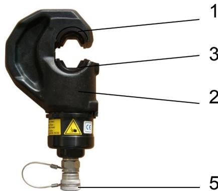
Zur Inbetriebnahme müssen die benötigten Presseinsatzhälften eingesetzt werden. Hierzu die Einsatzschalen in die Führungen im C-Kopf (1) und im Kolben (2) einführen. Die Kugelspannschraube (3a) niederdrücken, den oberen Einsatzhalter (3b) anziehen und die Einsatzhälften weiter in die Führungen schieben, bis sie fühlbar eingerastet sind.
